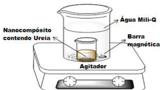
Figura 1. Sistema utilizado para retirar as alíquotas para as medidas de dessorção de ureia
