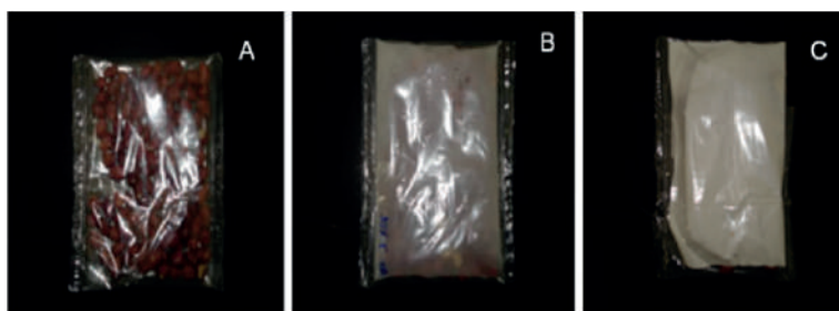
Figura 1. Amendoins embalados em filmes incorporados com óleo essencial de funcho doce nas concentrações de 0% (A), 30% (B) e 60% (C).
